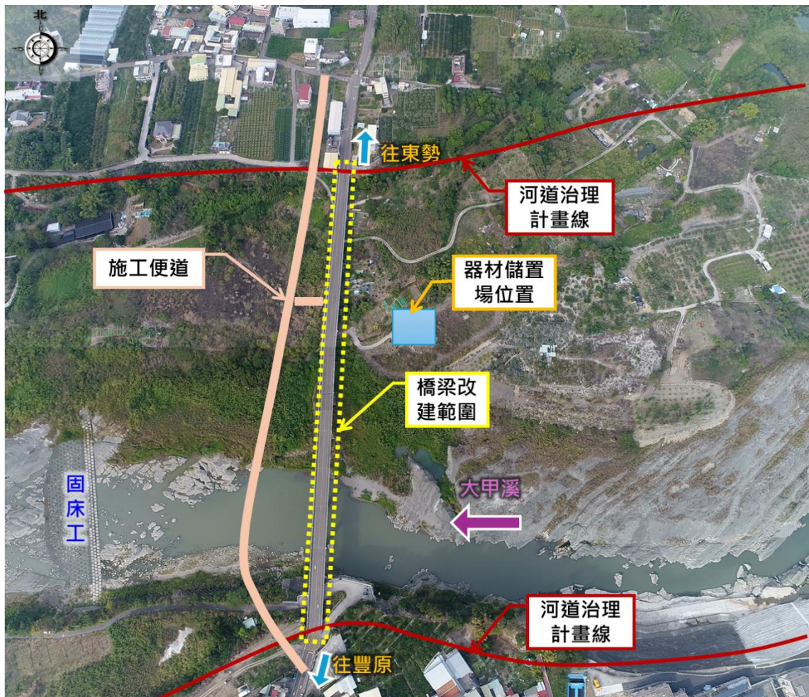
圖 5.4-1 施工範圍、施工動線及材料堆置區
